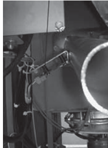
Abb. 2.10 Den Luftsensord mit einem weichen Pinsel reinigen
