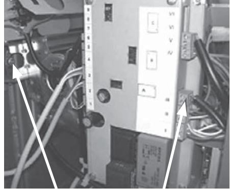
Abb. 1.4 Linke Befestigungsmutter für das Konvektionsluftgebläse und Anschlussstecker an Position ' III '
