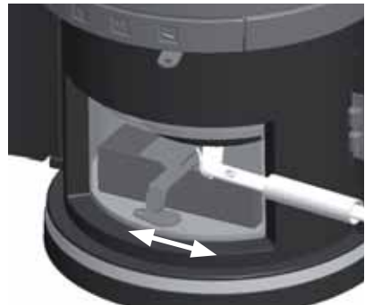
Fig. 2,12 Manœuvrer la grille à secouer avec la poignée de commande
