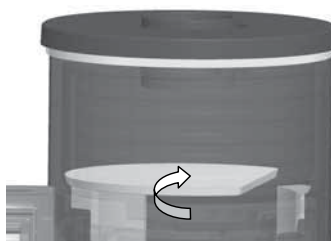
Fig. 2,19 ...faire pivoter de 90°. Puis la retirer.
