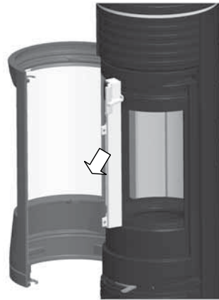
Fig. 5,4 Ne démonter qu'un conduit de ventilation latéral
