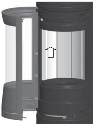
Fig. 5,5 Retirer d'abord le côté gauche du segment de pierre, puis démonter l'arrière et le côté droit
