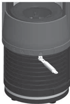
Fig. 2,3 Utilisation de la poignée de commande pour régler l'air de combustion
